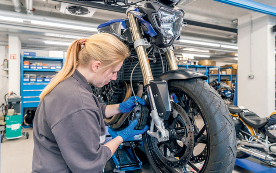
◀ Jennifer von Büren installe un nouveau système de freinage.
